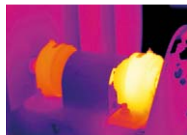
Oververhitting van lagerkap
